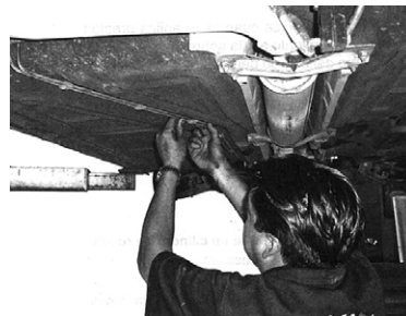
Revisión de la tubería de frenos
