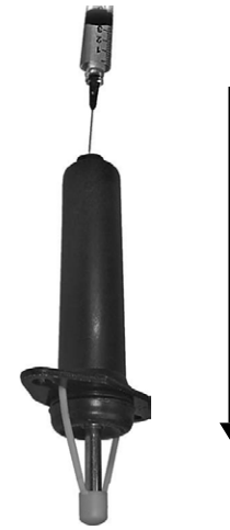
Llenado del cilindro de clutch en posición vertical
