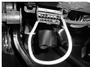
Punteando las terminales del conector DLC
